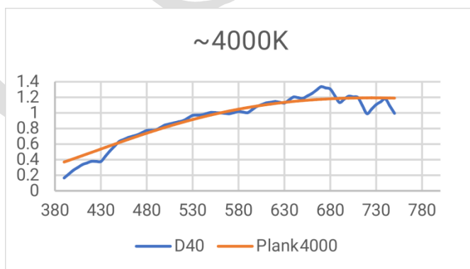
图 A.2 报告建议的 4000K 的 D 光源及 4000K 黑体辐射的相对光谱功率分布对照图
